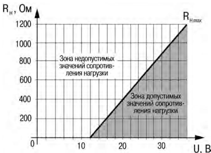
Рисунок 2.1 – График для выбора допустимых значений сопротивления нагрузки
